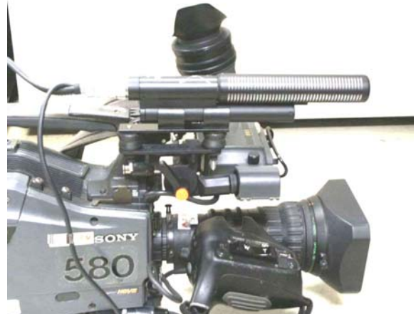
マイクマウント用 アタッチメント(26mm) K-BWC と、マイクホルダー WGS-5 を使用したカメラへの装着例
